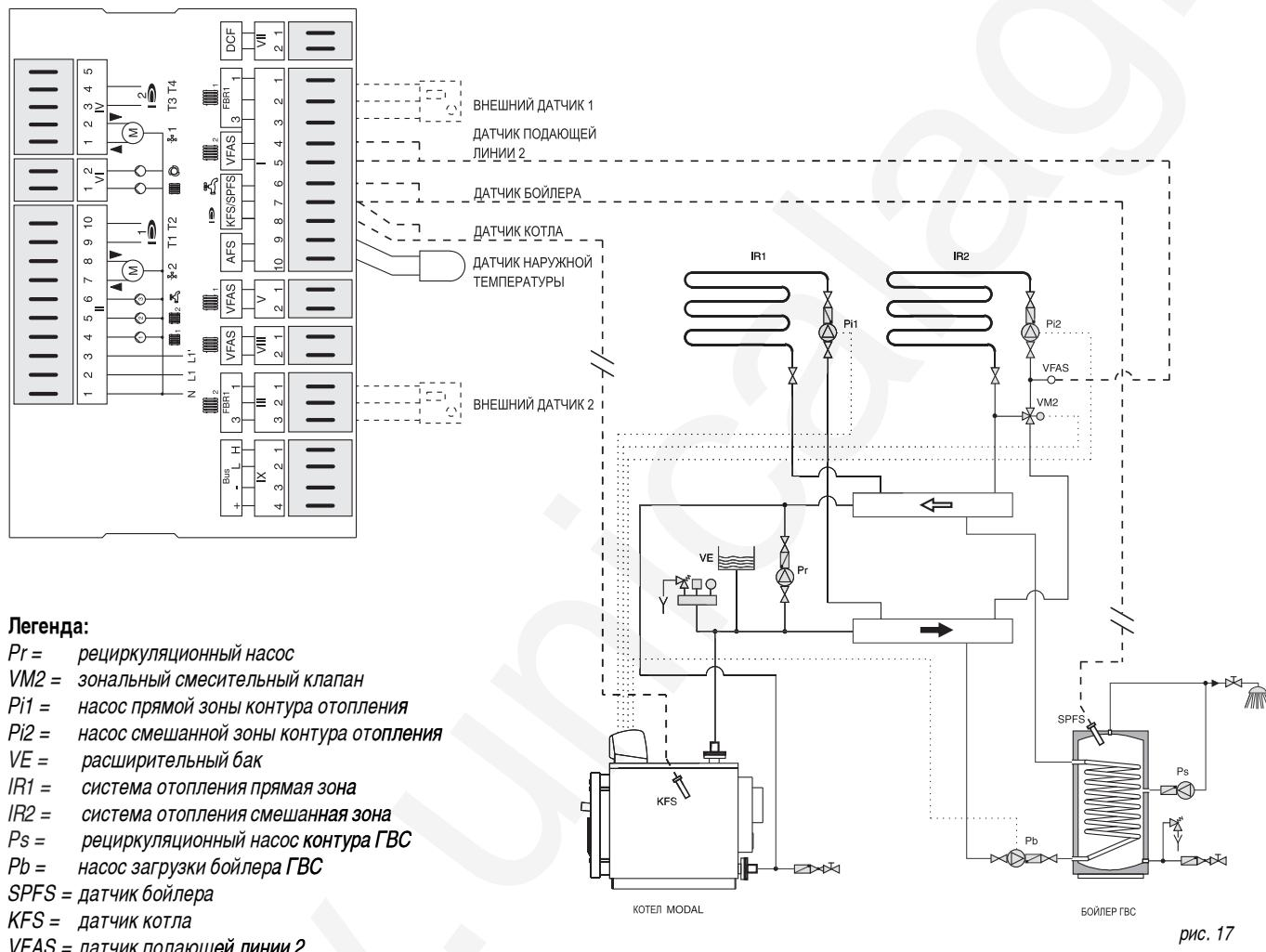
Дополнительная панель управления котла MODAL автоматически управляет выключением горелки, когда котел достигает температуры, заданной на терморегуляторе.
